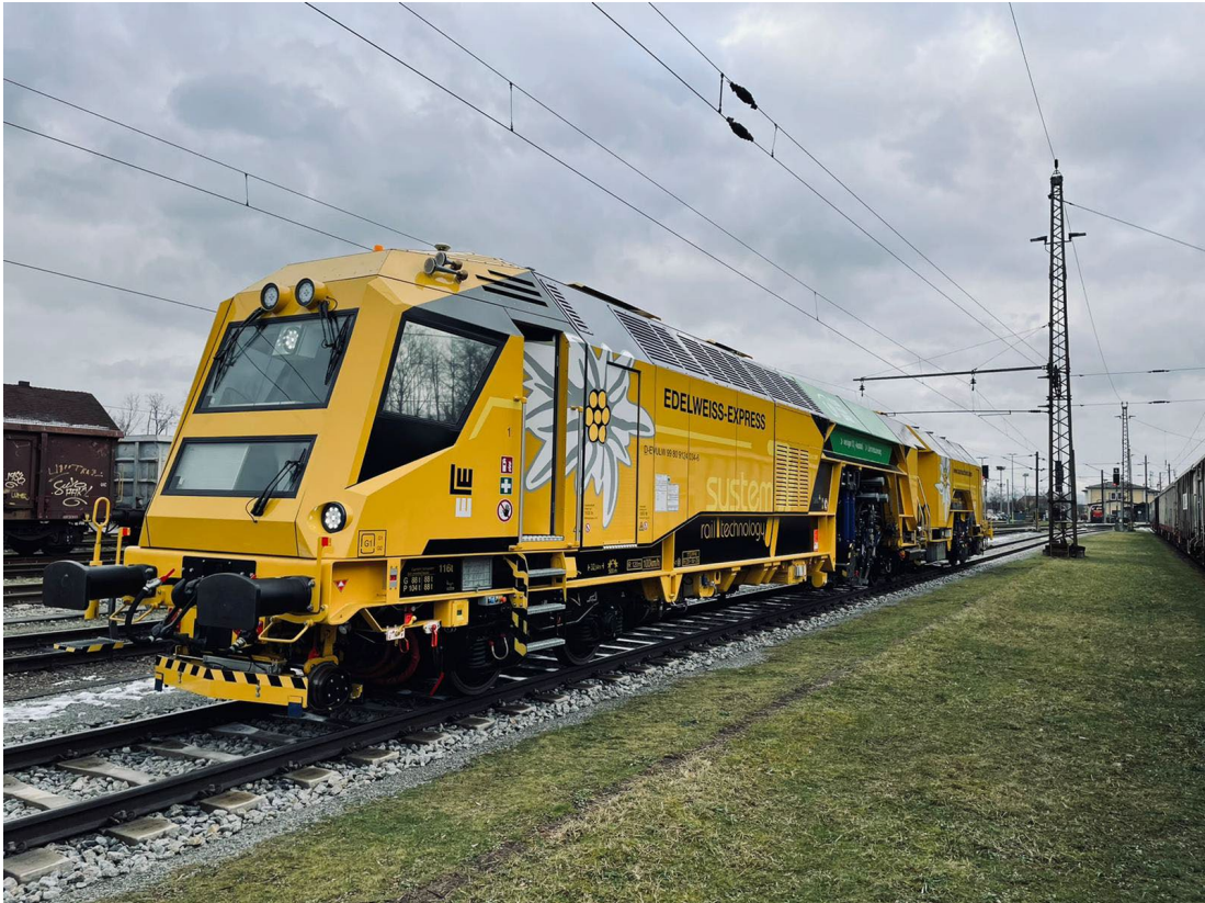
Der neue Gleisstopfroboter S7 PLS 16 4.0 – S mit dem Namen EDELWEISS-EXPRESS.
